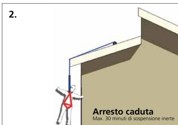
Progettare in **arresto caduta** vuol dire avere più punti a rischio caduta. Per tale progettazione è fondamentale calcolare il tirante d'aria. Si deve considerare la freccia massima della Linea Vita, la presenza di ostacoli attorno all'edificio ed inserire nel fascicolo tecnico il piano di intervento per il rapido soccorso (entro massimo 30 min).
