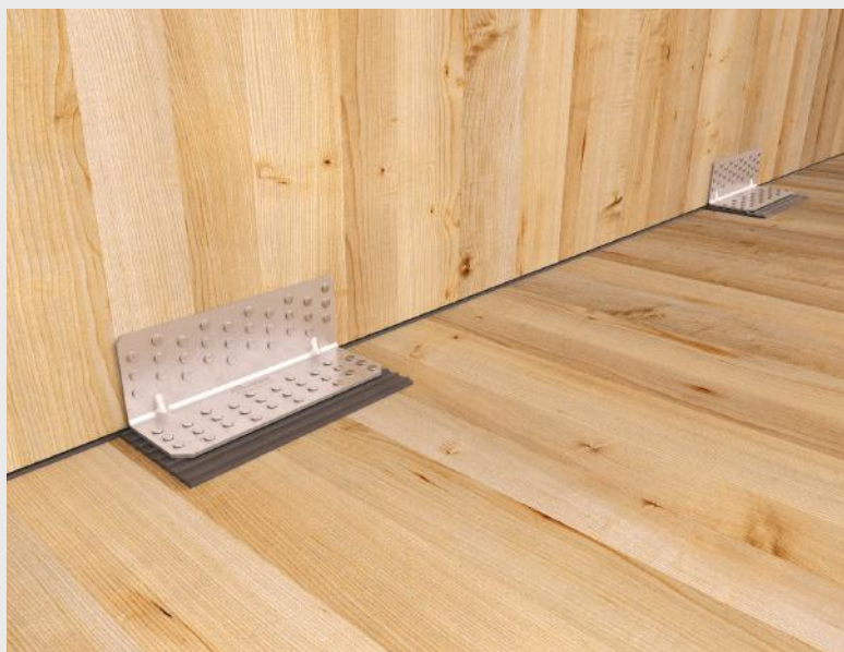
Sistema di connessione realizzato con angolare a taglio TITAN SILENT e striscia fonoisolante ALADIN STRIPE.
