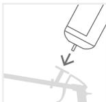
8. Per non danneggiare il filetto d'attacco della bomboletta, posizionarla orizzontalmente e avvitare sulla pistola lentamente.
