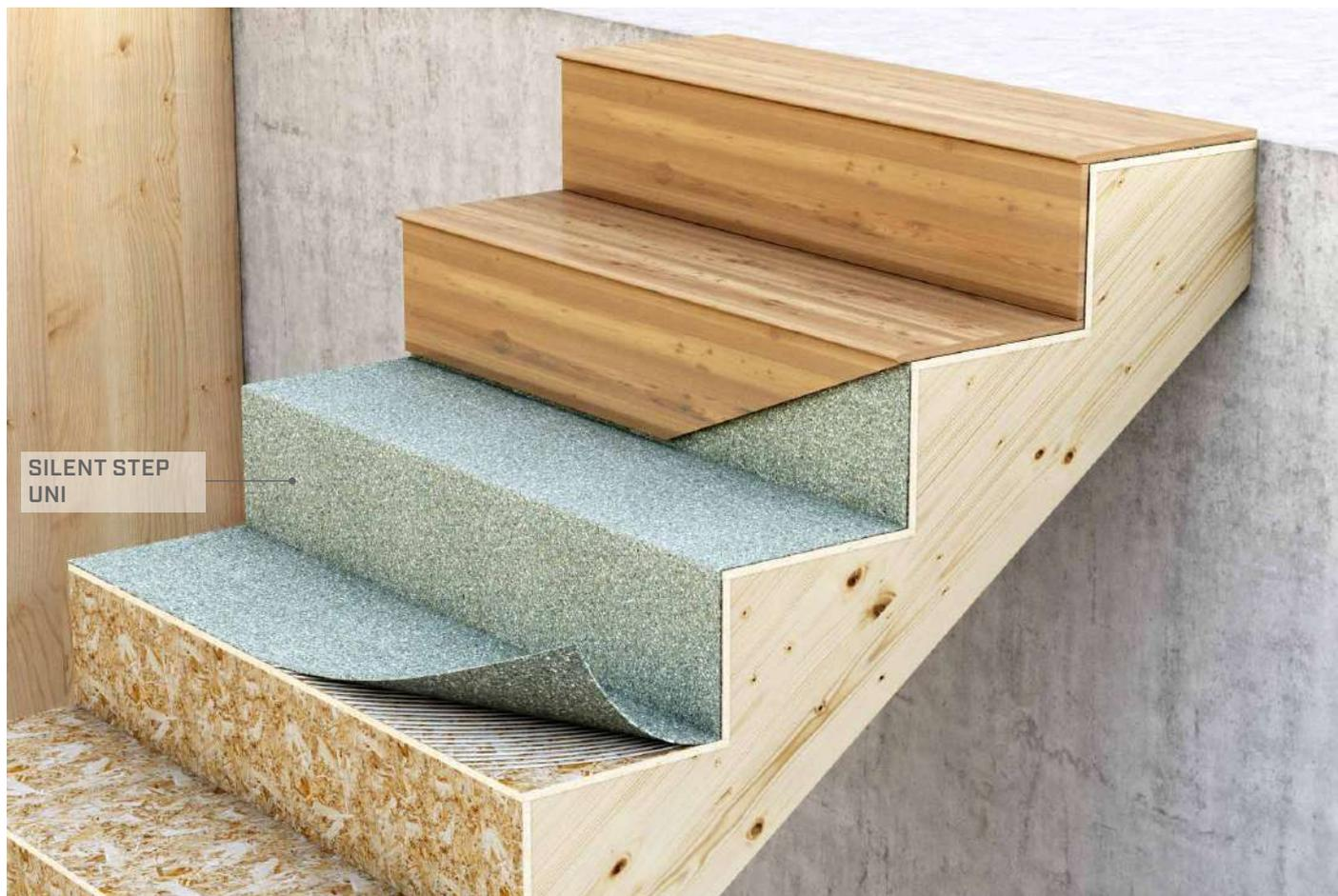
Corpo scala in legno lamellare/massiccio e scalini in OSB con pavimentazione flottante.
