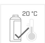
5. La temperatura ottimale di utilizzo è di 20°C; al di sotto di questa temperatura l'espansione è rallentata, al di sopra la schiuma può perdere efficacia.
